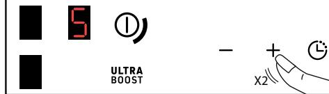
Met een vermogen > 5, brengt een snelle dubbele druk op de + toets u direct naar vermogen 9.
