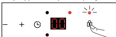
Na wyświetlaczu pracujących stref gotowania pojawia się teraz na przemian symbol zasilania i symbol blokady .
