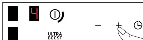
Con una potenza < 5, una rapida doppia pressione sul pulsante + permette di accedere direttamente alla potenza 5.
