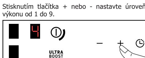
Při výkonu < 5 umožňuje rychlé dvojité stisknutí tlačítka + přímý přístup k výkonu 5.
