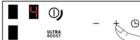
Met een vermogen < 5, geeft een snelle dubbele druk op de + toets direct toegang tot vermogen 5.
