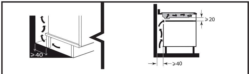
o di un forno a incasso (1.2.5), rispettare le dimensioni indicate sulle illustrazioni al fine di assicurare un'uscita d'aria sufficiente sulla parte anteriore.
