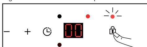
Il display delle zone di cottura in funzione mostra ora alternativamente il simbolo di potenza e il simbolo di blocco .
