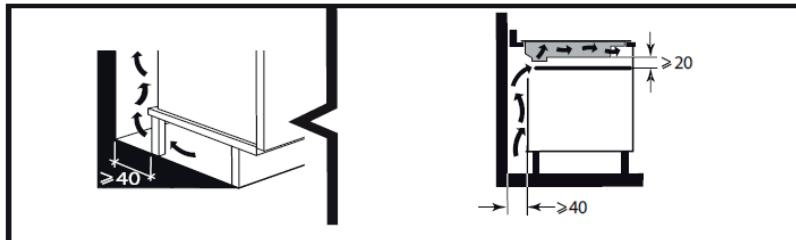
ou por cima de um forno encastrável, respeite as dimensões anotadas nas ilustrações para assegurar uma saída de ar suficiente na parte da frente.
