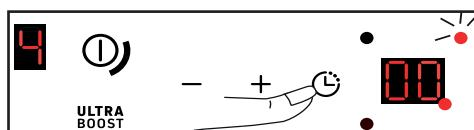
Zera timer migają wraz z diodą LED jednostek timera i diodą LED aktywnej ostrości.
