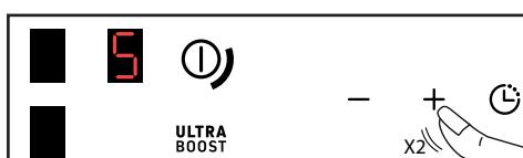
Při výkonu > 5 se rychlým dvojitým stisknutím tlačítka + dostanete přímo na výkon 9.
