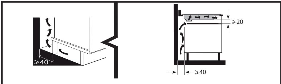
of een ingebouwde oven wordt geïnstalleerd, respecteer dan de afmetingen aangegeven in de afbeeldingen om een voldoende luchtafvoer te waarborgen aan de voorzijde.
