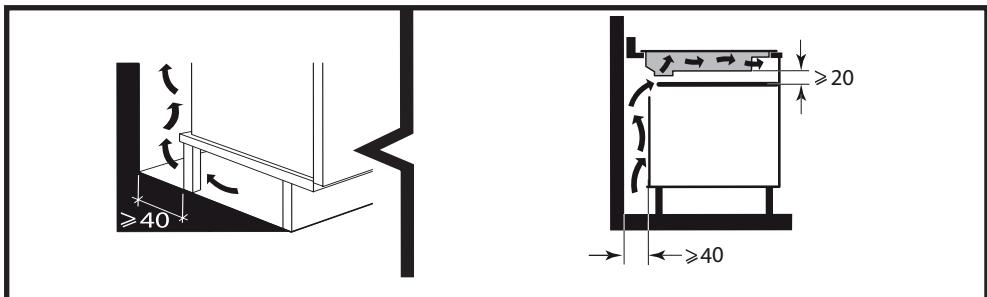
lub piekarnikiem przeznaczonym do zabudowy należy przestrzegać wymiarów wskazanych na ilustracjach, aby zapewnić niezbędny przepływ powietrza wylotowego z przodu urządzenia.
