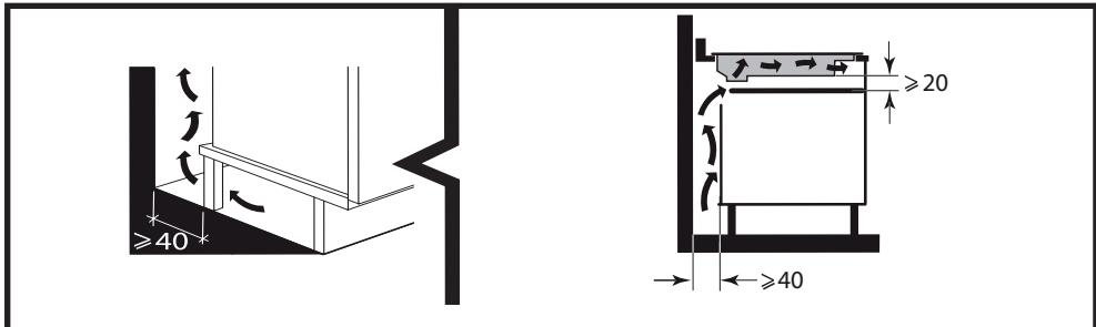
Eller over en innebygd ovn, følg dimensjonene som er notert på illustrasjonene for å sikre et tilstrekkelig luftuttak.
