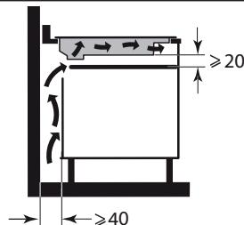
oder über einem einbaubaren Backofen installiert wird, halten Sie die auf den Abbildungen angegebenen Abmessungen ein, damit die Luft gut nach vorne ausströmen kann.
