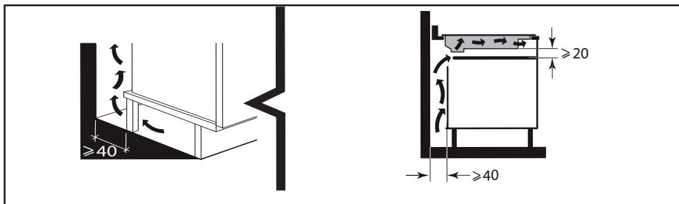
eller over en indbygningsovn, skal målene på illustrationerne overholdes for at sikre tilstrækkeligt luftudtag på forsiden.
