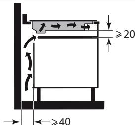
ou au-dessus d'un four encastrable, respectez les dimensions notées sur les illustrations afin d'assurer une sortie d'air suffisante à l'avant.
