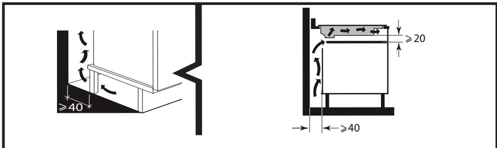
o un horno empotable, respete las dimensiones indicadas en las imágenes para garantizar una salida de aire suficiente por delante.
