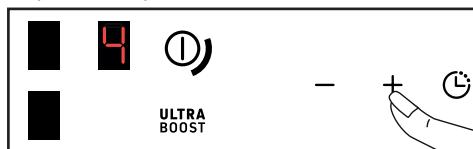
Con una potencia < 5, una rápida doble pulsación de la tecla + permite acceder a la potencia 5.
