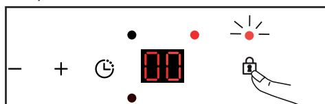
L'affichage des zones de cuisson en fonctionnement indique alors en alternance la puissance et le symbole de verrouillage .
