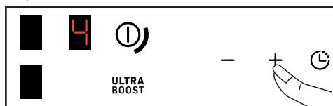
Avec une puissance < à 5, un double appui sur la touche + permet d'accéder directement à la puissance 5.
