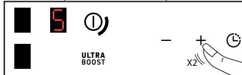
Con una potencia > 5, una rápida doble pulsación de la tecla + permite acceder a la potencia 9.
